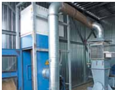
Расслаивающая отсадочная машина allair® для циклических тестов
